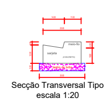
Detalhe do Meio-Fio com Sarjeta (DER Tipo 7 - 0,031 m/m) (medidas em centímetros)
