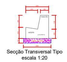
Detalhe do Meio-Fio com Sarjeta (DER Tipo 2 - 0,042 m/m) (medidas em centímetros)
